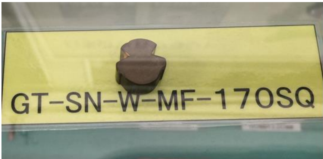
圖 3.4 日本高鐵使用之特殊新式接觸線斷面圖
