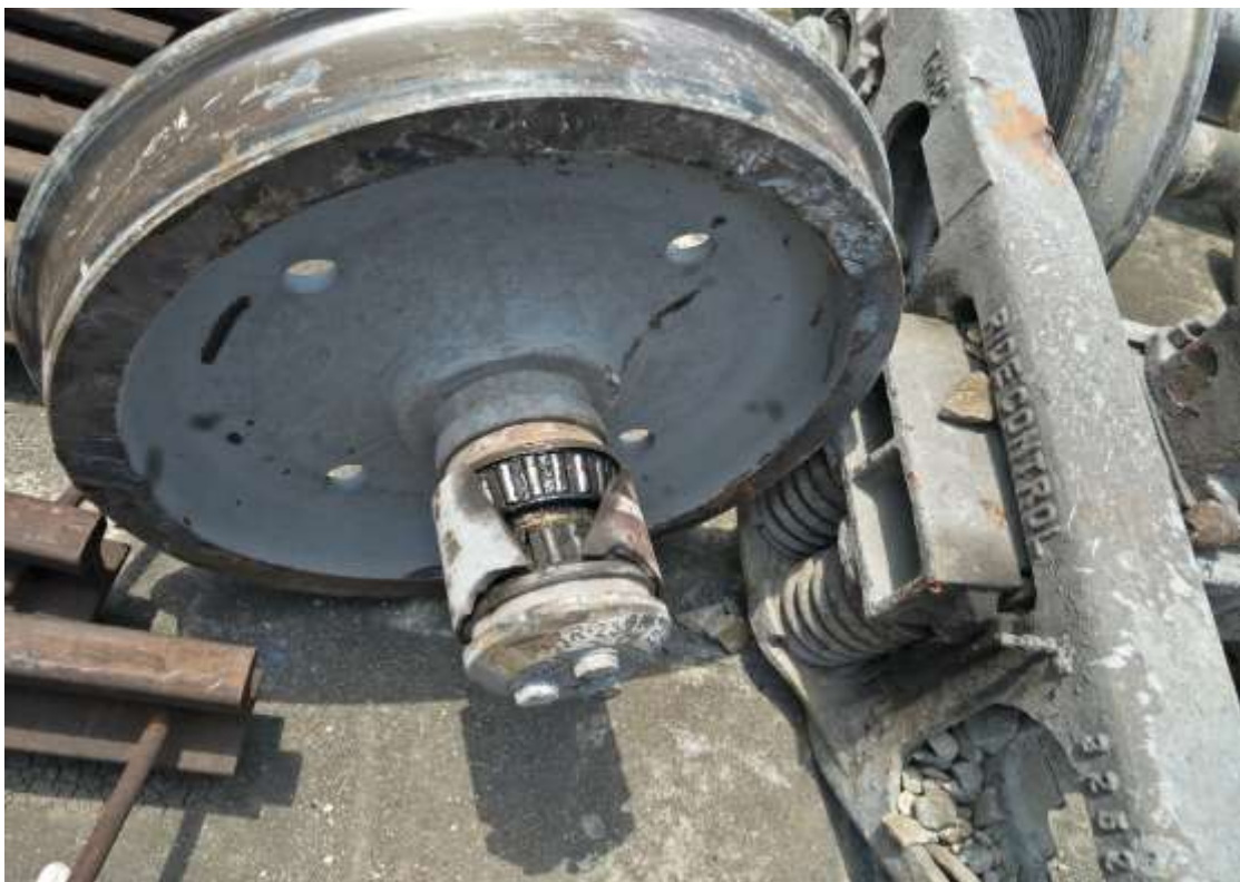
圖 3.2.3-5 同軸另一側軸承蓋破損，滾珠並無異常磨損
