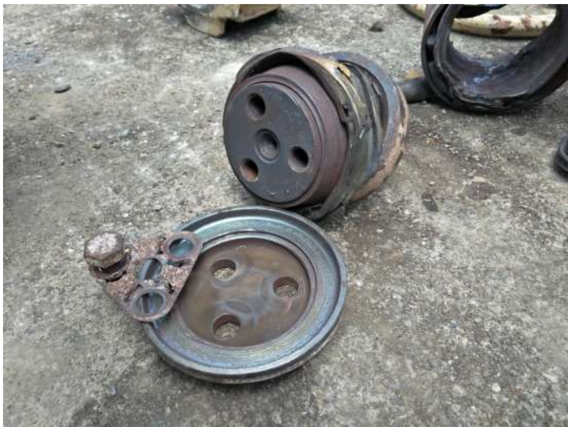
圖 3.2.2-6 軸承外蓋螺絲孔並無損壞情形
