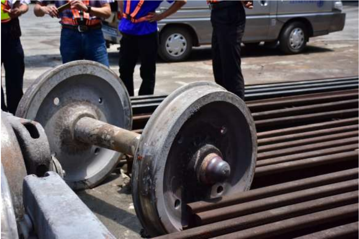
圖 3.2.2-2 軸承熔毀破裂並將輪軸軸頸熔斷
