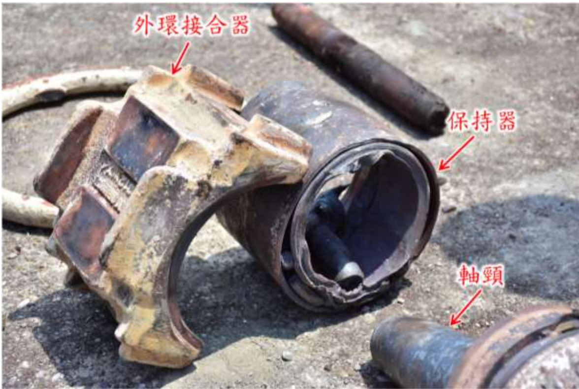
圖 3.2.2-4 軸承熔毀破裂並將輪軸軸頸熔斷
