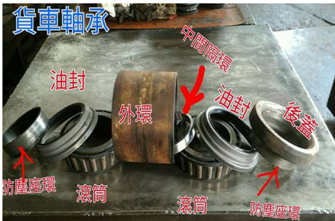
圖 3.2.2-7 正常貨車軸承構造
