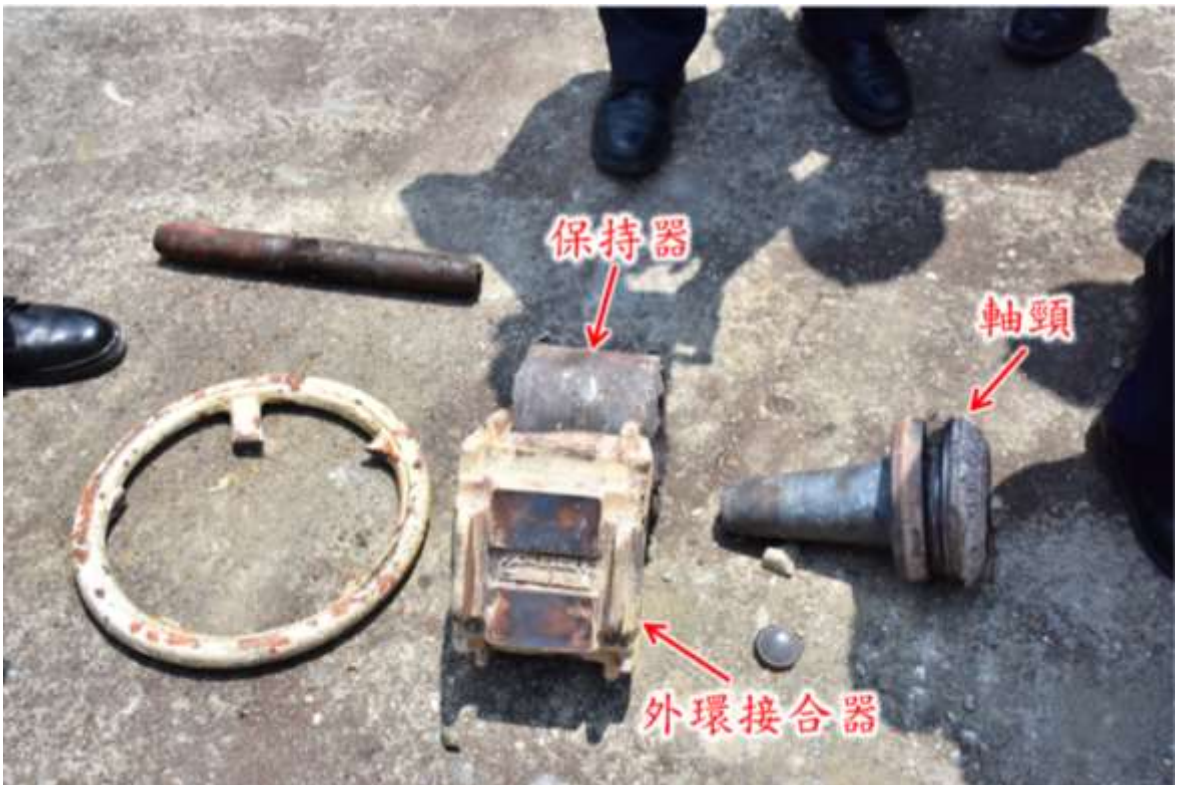
圖 3.2.2-3 軸承熔毀破裂並將輪軸軸頸熔斷
