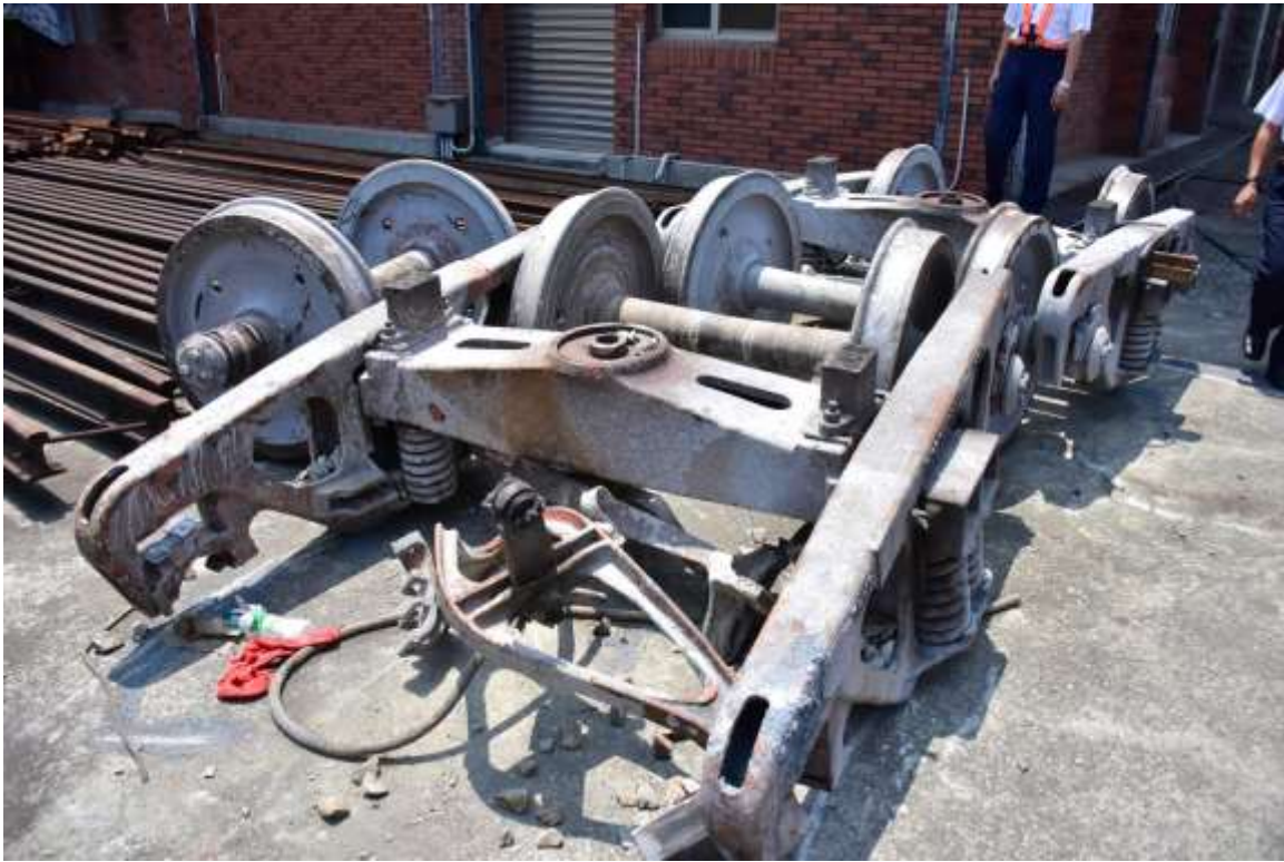
圖 3.2.2-1 轉向架之框架因出軌撞擊致嚴重變形
