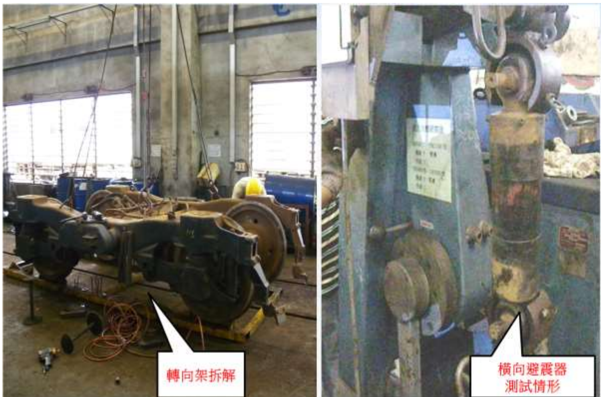
圖 3.2.2-3 轉向架及其橫向油壓避震器檢測照片
